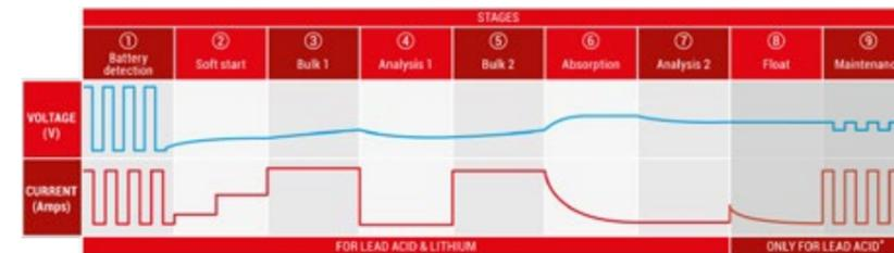
\*Algoritmo de carga adaptable para baterías de litio: Sin etapas de flotación ni mantenimiento. Una vez que la batería está completamente cargada, la carga se detiene automáticamente.
